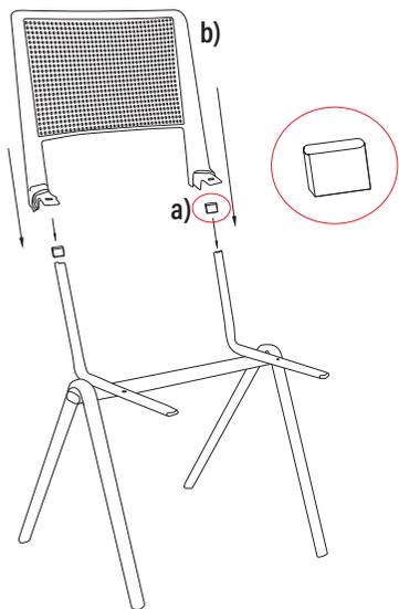
**Passo 02:** Posicionar o assento (item 02) com a parte inferior voltada para cima e encaixar a haste do assento (item 04). Pressionar a haste sobre os encaixes do assento para encaixar, conforme ilustração.
