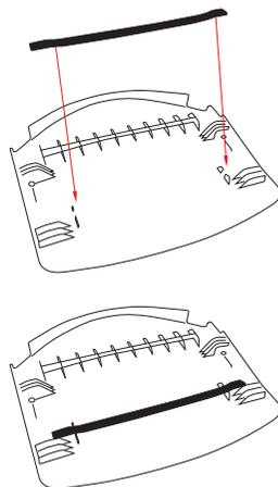
**Passo 03:** Posicionar a estrutura fixa (item 03) sobre um apoio e introduzir o assento (item 02), através dos suportes da estrutura fixa, conforme ilustração.
