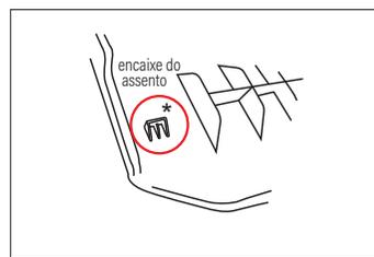
**Passo 05:** a) Verificar se as furações do assento estão alinhadas com a furação da estrutura fixa. b) Se os encaixes e furações estiverem alinhados, parafusar com 1 parafuso (item a) para cada lado.
